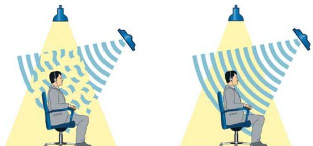
Verzerrter Empfang (links) bei anderen Audioübertragungssystemen und perfekter Empfang (rechts) beim Bosch Integrus Audioübertragungssystem
